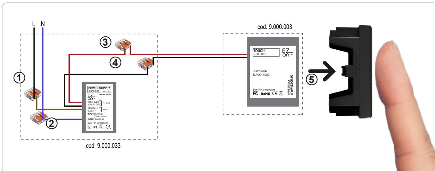
**Ezon.io Touch** cod. 9.000.003 per poter funzionare necessita di un alimentazione a 5vdc (consigliato l'utilizzo di ezon.io power supply 9.000.033).
