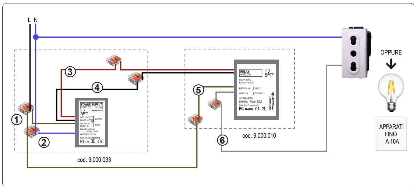
**Ezon.io Relay cod. 9.00.0.010** per poter funzionare necessita di un alimentazione a 5vdc (consigliato l'utilizzo di ezon.io power supply 9.000.033).
